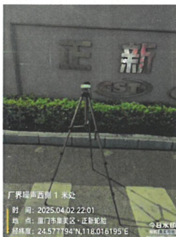
厂界噪声西侧 1 米处 (夜间)
